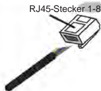
Abbildung 3.22 Entfernen Sie die Isolierschicht und verbinden Sie den RJ45-Stecker.
